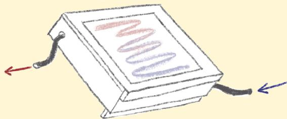
1 vider le radiateur et le remplir d'eau vinaigrée pour éviter la corrosion à l'intérieur. Le reviser ensuite
