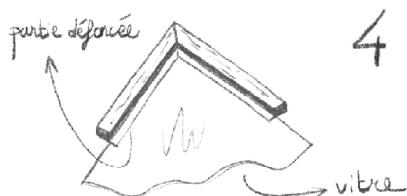
4 défoncer les planches du couvercle pour, une fois assemblées, coller la vitre avec du silicone transparent.
